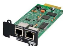
La Tarjeta de Red MS permite al 9PX conectarse con una red Ethernet y con Internet, dando soporte a un monitoreo y control en tiempo real del UPS a través de la red por medio de un navegador Web estándar, un sistema de administración de red en cumplimiento con SNMP o con software de administración de energía.
